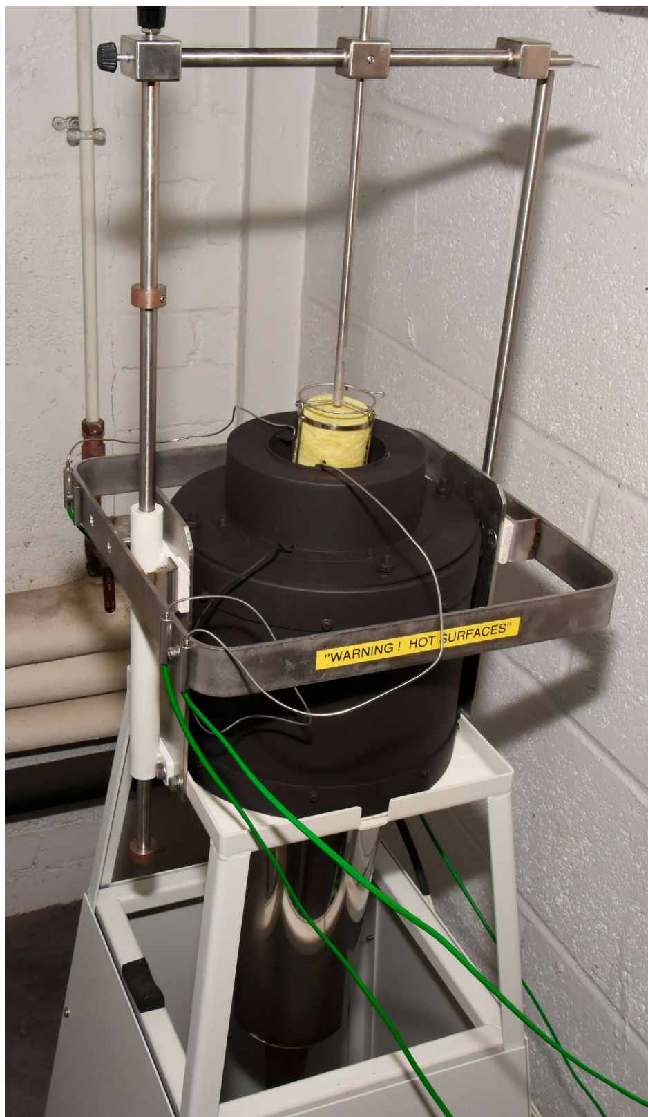
Figure A.6 – BS EN ISO 1182 test apparatus
